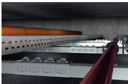
Применение соединителя профиля при сборке монтажной сетки
