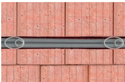
Крепление кабелей в штробах стен шириной > 30 мм
