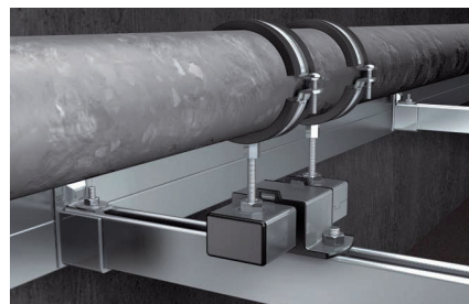
Удлинение трубопровода с помощью скользящей опоры
