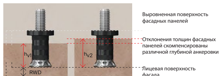
Дистанционный монтаж с помощью анкера FZP II SO в панель из некалиброванного камня
