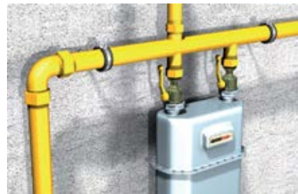
Крепление газовых расходомеров
