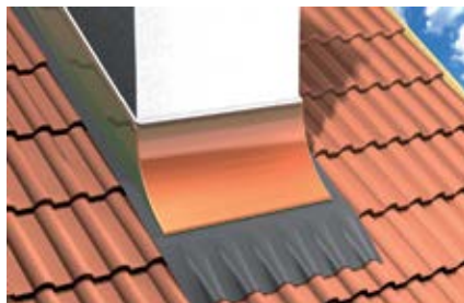
Герметизация фартуков вокруг дымоходов
