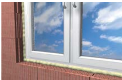
Швы оконных соединений
