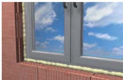
Швы оконных проемов
